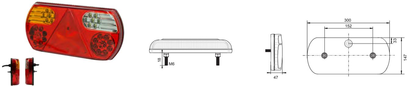
Blinklicht ✓ Standlicht ✓ Bremslicht ✓ Nebenschlusslicht ✓ Rückfahrlicht ✓ Rückstrahler ✓
