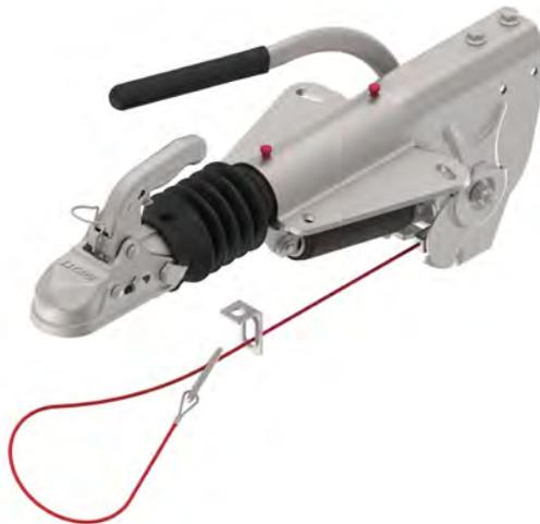
Auflaufeinrichtung von oben auf die Zugdeichsel montiert
