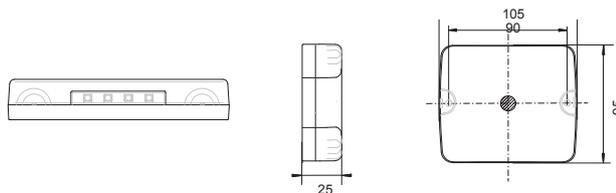
Rückfahrlicht ✓ Rückstrahler ✓ Nebelschlusslicht ✓
