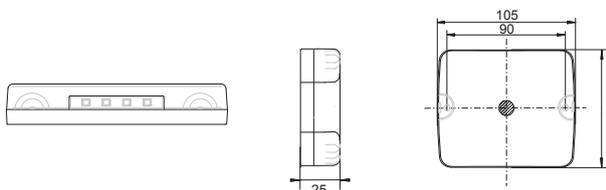
Blinklicht ✓ Standlicht ✓ Bremslicht ✓ Rückstrahler ✓
